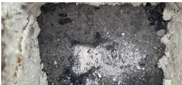
Prélèvement - P054 : Extérieur / Toiture terrasse - Sol coulé- (Absence d'amiante)
