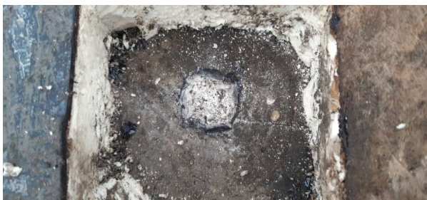
Prélèvement - P058 : Extérieur / Toiture terrasse - Sol coulé- (Absence d'amiante)
