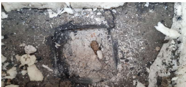
Prélèvement - P050 : Extérieur / Toiture terrasse - Sol coulé- (Absence d'amiante)
