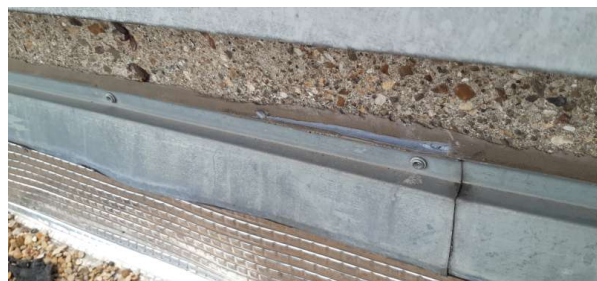
Prélèvement - P065 : Extérieur / Toiture terrasse - Mastic- (Absence d'amiante)
