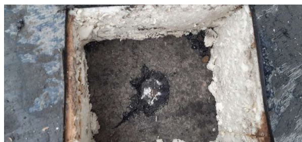
Prélèvement - P053 : Extérieur / Toiture terrasse - Pare-vapeur- (Absence d'amiante)
