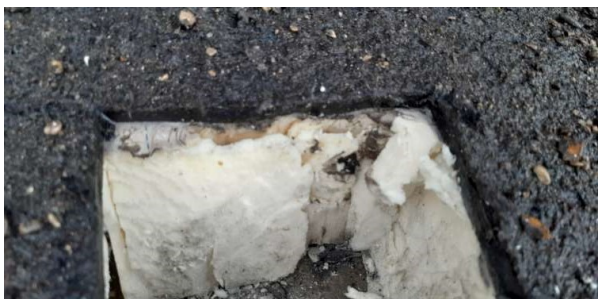
Prélèvement - P048 : Extérieur / Toiture terrasse - Isolant- (Absence d'amiante)
