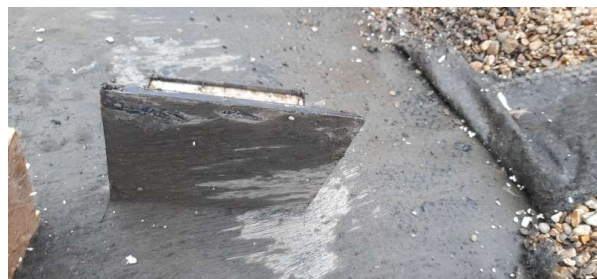
Prélèvement - P051 : Extérieur / Toiture terrasse - Revêtement d'étanchéité- (Absence d'amiante)
