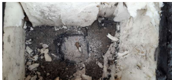
Prélèvement - P049 : Extérieur / Toiture terrasse - Pare-vapeur- (Absence d'amiante)
